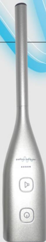
Компактное устройство с автономным питанием и беспроводным режимом заряда, которое выявляет гамма-излучение и реагирует на него одновременно звуковыми сигналами и выводом зарегистрированного уровня гамма-излучения на дисплее числовыми значениями счётчика.
